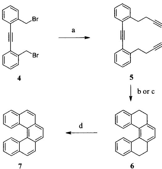
**Scheme 1.** (a)  $\text{LiCH}_2\text{C}\equiv\text{CTMS}$  (2.2 equiv), THF,  $-78^\circ\text{C}$ , 1 h, then  $n\text{-Bu}_4\text{NF}$  (8 equiv) in THF, rt, 16 h, 67 %; (b)  $\text{CpCo}(\text{CO})_2$  (20 mol %),  $\text{PPh}_3$  (40 mol %), decane, irrad.,  $140^\circ\text{C}$ , 1 h, 72 %; (c)  $\text{Ni}(\text{cod})_2$  (20 mol %),  $\text{PPh}_3$  (40 mol %), THF, rt, 0.5 h, 66 %; (d) DDQ (6 equiv), benzene,  $100^\circ\text{C}$ , 40 h, 72 %.
